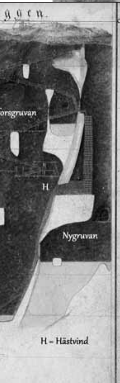
Grundsjögruvan på 85 meters avvägning (djup). Hästvinden som är inritad på kartan här var den som låg djupast i gruvan. Här syns också trärampen som hästarna gick upp och ned på. Notera också det stora trägolvet som byggts över det öppna rummet vilket hästen gick runt på dagarna i ända. Det blev nog en hel del hästskit i gruvan att ta reda på under ett år!
